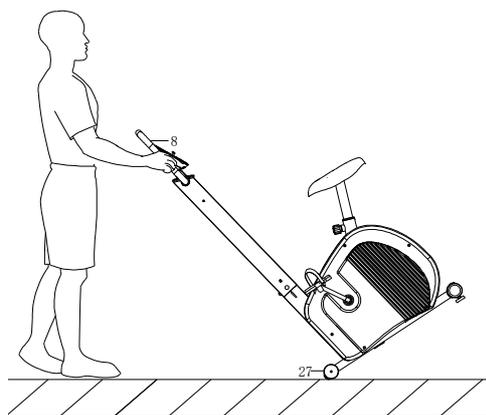
Per spostare la macchina, spingere il manubrio(8) fino a quando le estremità delle ruote di trasporto(27) sul tubo inferiore anteriore toccano il suolo. Con le ruote a terra, è possibile trasportare la bicicletta nel luogo desiderato con facilità.
