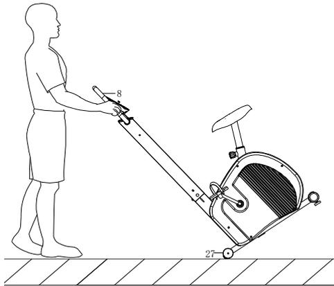
Um das Gerät zu bewegen, drücken Sie den Lenker(8), bis die Endkappen der Transporträder(27) am vorderen Unterrohr den Boden berühren. Wenn die Räder auf dem Boden stehen, können Sie das Fahrrad problemlos an den gewünschten Ort transportieren.
