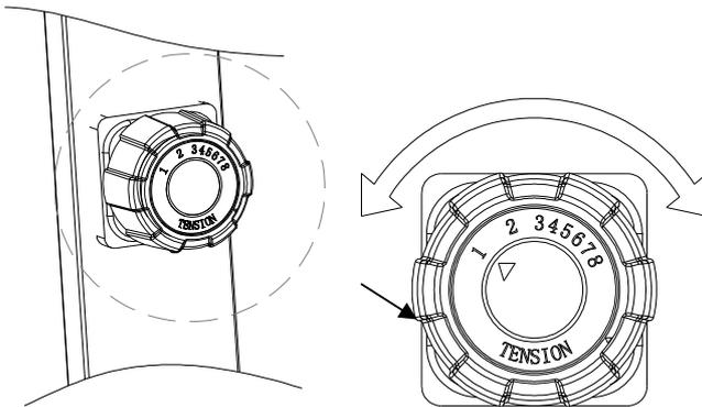
Tournez le bouton de tension (17) dans le sens des aiguilles d'une montre pour augmenter le niveau de résistance, tournez le bouton de tension dans le sens inverse des aiguilles d'une montre pour diminuer le niveau de résistance. Le niveau 1 est le plus bas et le niveau 8 est le plus élevé.
