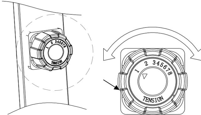
Draai de spanningsknop (17) met de klok mee om het weerstandsniveau te verhogen, draai de spanningsknop tegen de klok in om het weerstandsniveau te verlagen. Niveau 1 is het laagst en niveau 8 is het hoogst.
