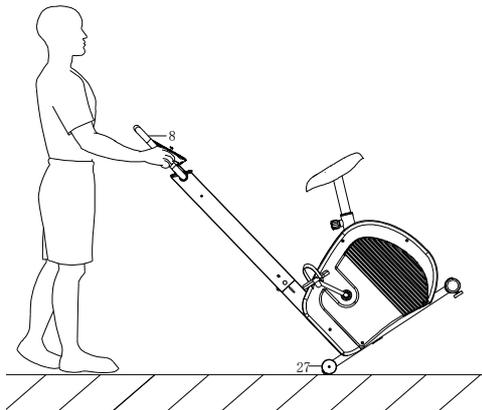
Pour déplacer l'appareil, poussez le guidon(8) jusqu'à ce que l'embout des roues de transport(27) sur le tube inférieur avant touche le sol. Une fois les roues au sol, vous pouvez facilement transporter le vélo jusqu'à l'endroit souhaité.
