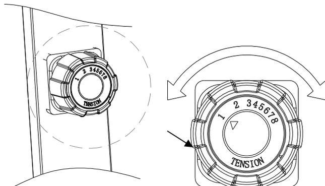
Gire el mando de tensión (17) en sentido horario para aumentar el nivel de resistencia, gire el mando de tensión en sentido antihorario para disminuir el nivel de resistencia. El nivel 1 es el más bajo y el nivel 8 es el más alto.
