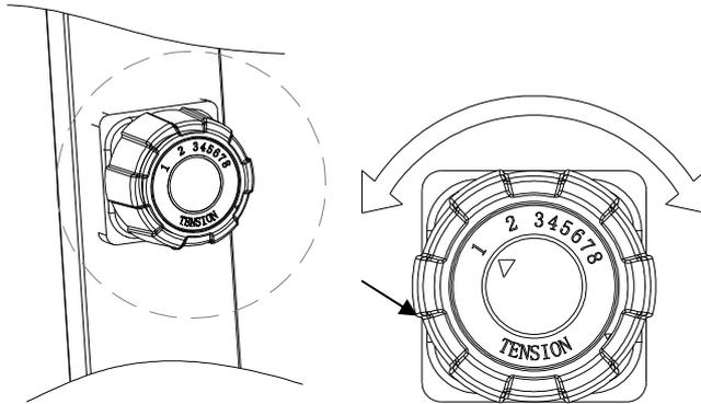
Drehen Sie den Spannungsregler (17) im Uhrzeigersinn, um den Widerstand zu erhöhen, drehen Sie ihn gegen den Uhrzeigersinn, um den Widerstand zu verringern. Stufe 1 ist die niedrigste und Stufe 8 ist die höchste.
